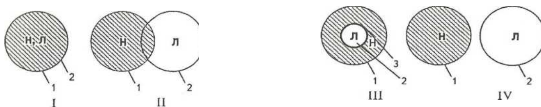
Рис. 1.2. Графічні варіанти взаємного розташування небезпечної зони 1, зони перебування людини 2 та засобів захисту 3
